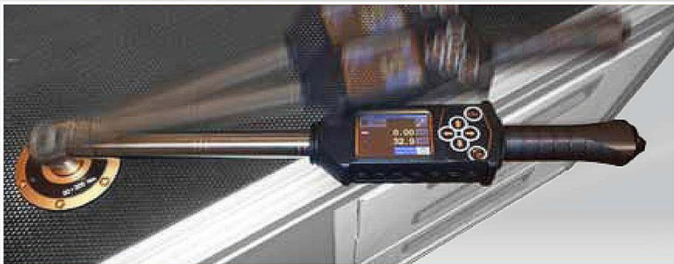
Ruční test kroutícího momentu / úhlu pro elektronické klíče.
